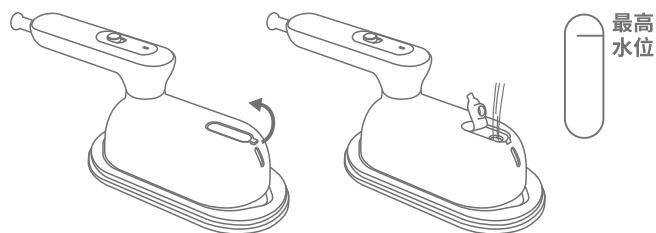
注意：切勿注入过量的水，以免溢出，影响本机器的正常使用。强烈建议使用纯净水，以延长本机的使用寿命。
